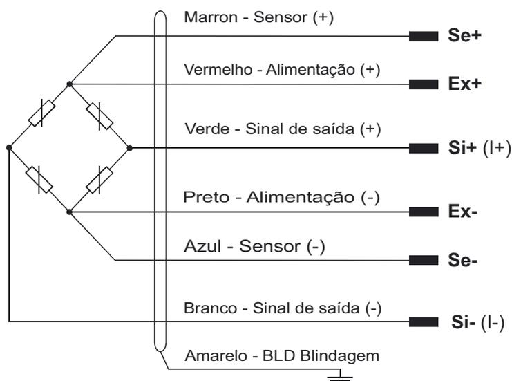
O cabo utilizado nesta célula de carga possui blindagem eletromagnética
